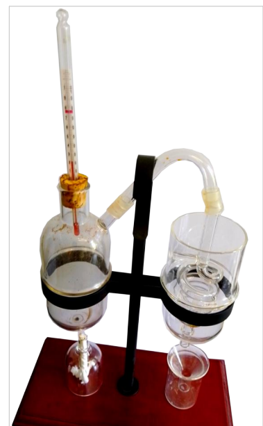
Einfache Destillationsanlage mit Kühlschlange
