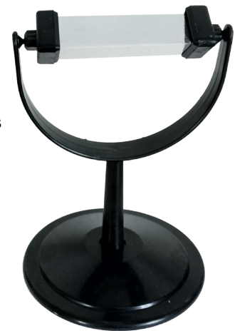
Prisma in einer Halterung zum Experimentieren
